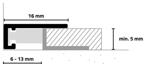
Per un risultato finale esteticamente perfetto e tecnicamente ineccepibile, è sufficiente fissare un angolare standard a L (con il lato lungo) al sottofondo prima di applicare lo spatolato, in modo da creare un giunto di collegamento di circa 10 mm di larghezza tra la parete ed il lato corto dell'angolare.
