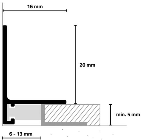
A questo punto viene applicato lo spatolato, poi liscio in direzione del binario angolare. Una volta che lo spatolato sarà completamente indurito e la parete completata, sarà possibile installare la minileiste nel giunto di collegamento.
